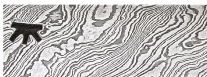
[a] - 80 rétegű csavart C45+90MnCrV8
