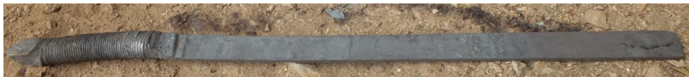
6. Ábra: A megcsavart rúd lapos keresztmetszetűvé kovácsolása
