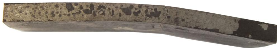
15. Ábra: Olajedzett C45 próbatest maradandó alakváltozása hajlítóvizsgálat után
