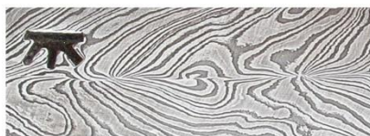
[b] - 2 x 40 rétegű csavart C45+90MnCrV8
