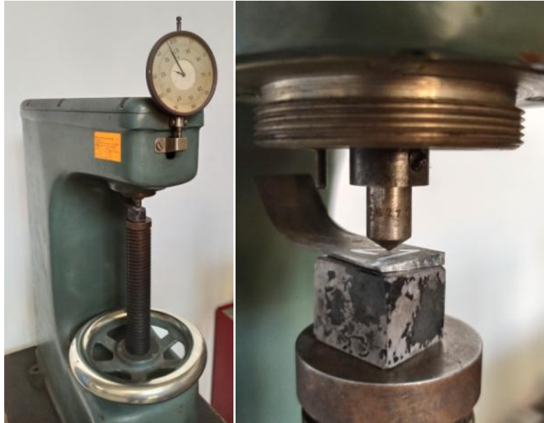
16. Ábra: HRc keménységmérések
