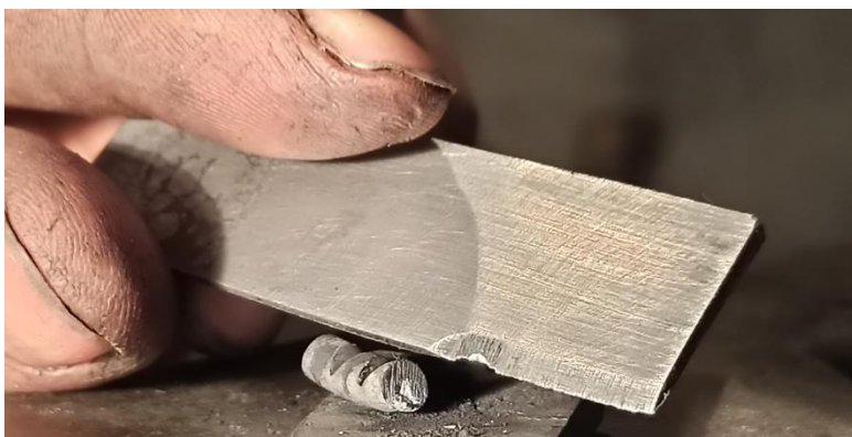
2. Ábra: Pengeszerű próbatestek „V” keresztmetszettel egy szakaszon leélezve vágáspróba után
