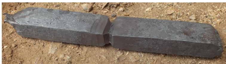
4. Ábra: 40 rétegű damaszkolt tömb közepén melegen bevágva félbetöréshez
