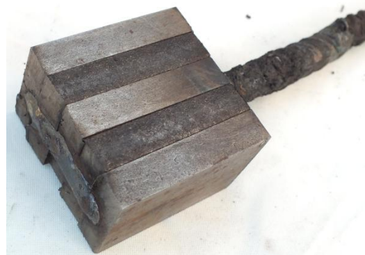
3. Ábra: Hegesztett előgyártmány a damaszkolt próbatestekhez. 3db C45-ös réteg fog közre 2db M1-es réteget. Az előgyártmány befoglaló méretei 50x30x10mm.
