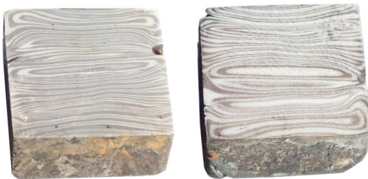
22. Ábra: Lágyított (balra) és olajédzett (jobbra) 160 rétegű C15+M1 minták 20x20x10mm-es befoglaló mérettel
